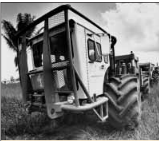
Fig. 2-11. Vehículos de diseño y tracción especial se emplean en las tareas de exploración sismográfica petrolera.
