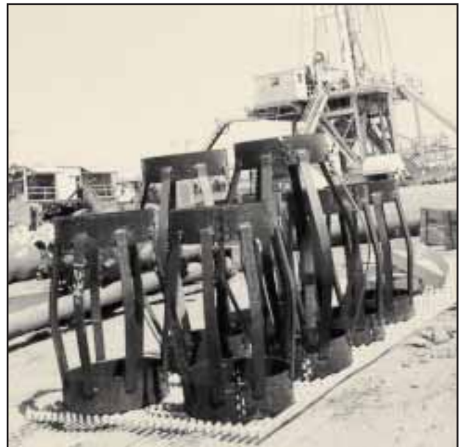
Fig. 3-34. Centralizadores para la sarta de revestimiento.
