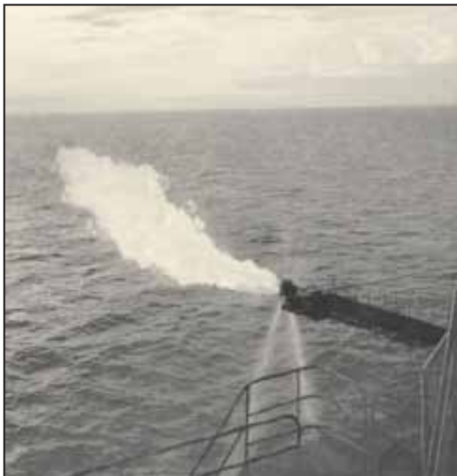
Fig. 5-5. La terminación de un pozo de gas natural, en tierra o costafuera, requiere que se hagan pruebas del volumen de producción de los yacimientos que se desean explotar. El comportamiento de la llama revela al operador ciertas características del caudal.
